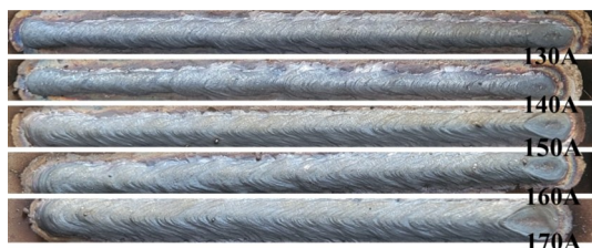
图6 不同焊接电流下的焊道形貌
