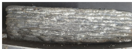
图 14 线能量 8 000 J/cm 墙体形貌
